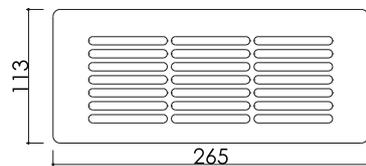
**Blende QUADRO (Lüftungsgitter 100 mm)**
