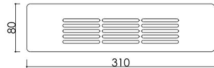
**Blende QUADRO slim (Lüftungsgitter 65 mm)**
