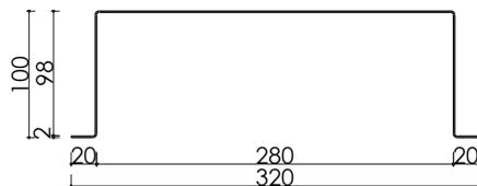
**Blende QUADRO (Lüftungsgitter 113 mm)**
