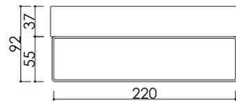
**Blende QUADRO slim (Lüftungsgitter 80 mm)**
